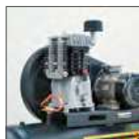
Tête de compression bi-étagée avec cylindre en fonte équipée de grandes ailettes pour un meilleur refroidissement.
