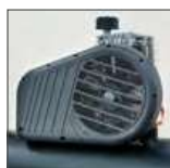
Carter de protection courroie.
